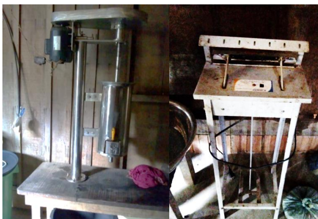
Figura 13: Máquina de despulpamento de açaí e termo seladora de embalagens.
